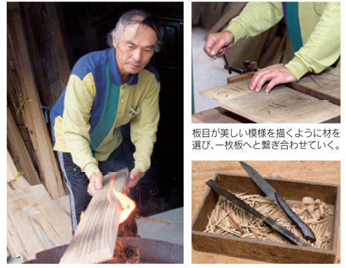
板は厚いほど上質の証。板に焼きを入れ、まっすぐにすることで崩れずに済む。美しい仕上がりに一役買ううづぎ。道具は、丹念に手入れがされている。
