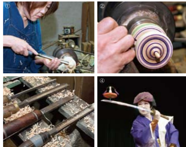
①独楽はもちろん、独楽を回す糸や独楽づくりの道具も自ら手づくりする ②発色の良い泥絵の具で彩色。昔から伝わる自然素材の見直しも行っている ③きれいな流涎が掛けるよう、ノミだけでも、幅や角度違いで10種類ある ④大舞台では、安定の良さから先代の博多独楽を使用することもある
