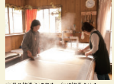
高温の乾燥板で紙を一気に乾燥させる
